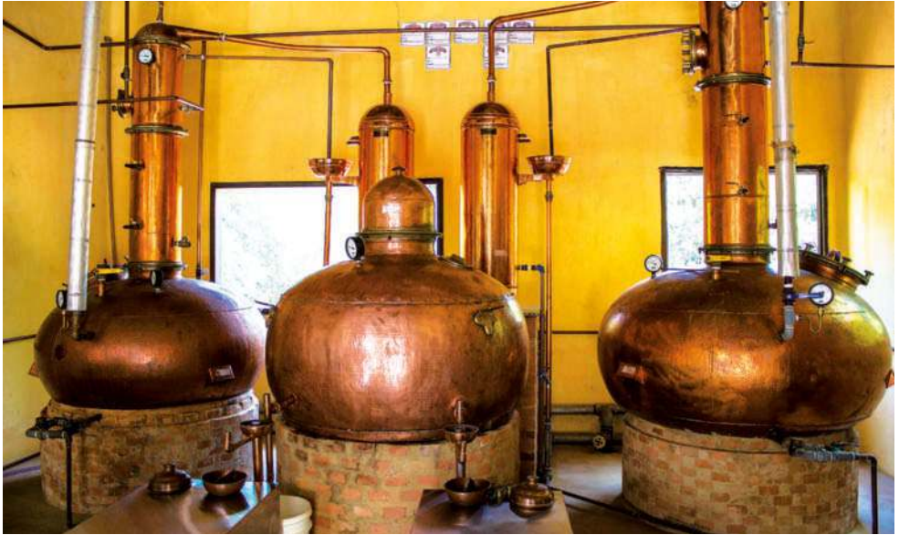
Eine Anlage mit drei Pot Stills für die Erzeugung von Cachaça.
